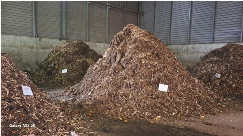
Figura 7. Pilas de compost de cada una de las mezclas de materia prima propuestas.
