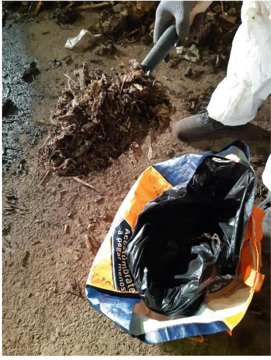
Figura 6. Toma de muestra en pilas de compost estudiadas.
