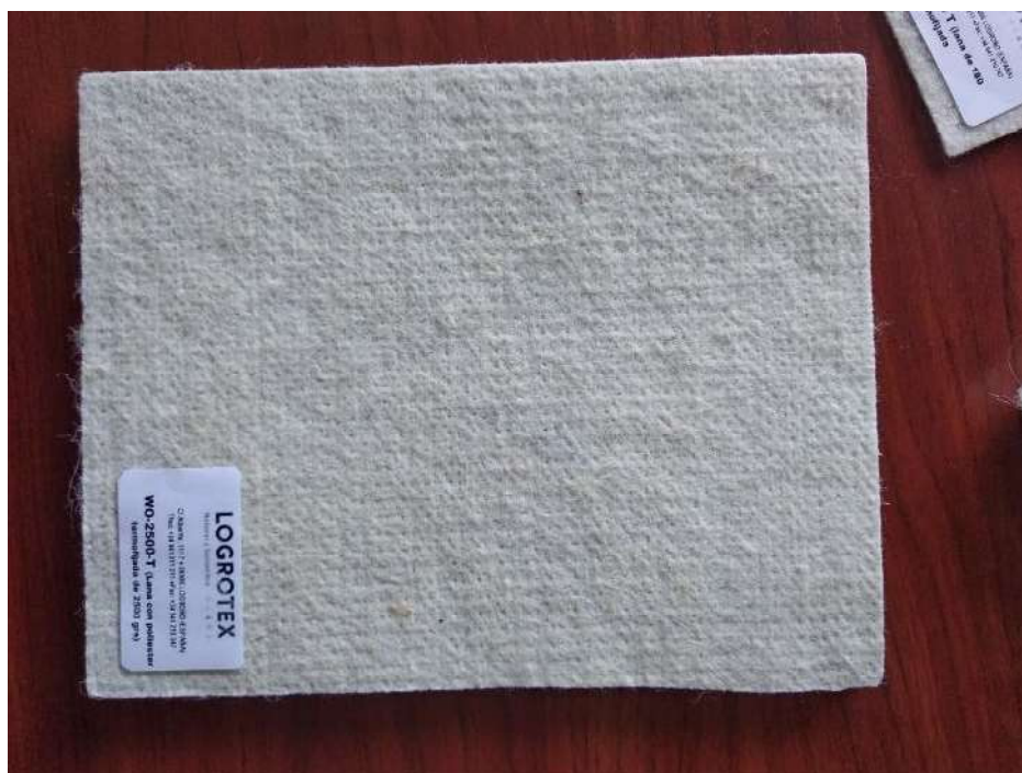
Foto 57. Aïllament acústic de llana i polièster punxonat. Font: Pròpia (2022).
