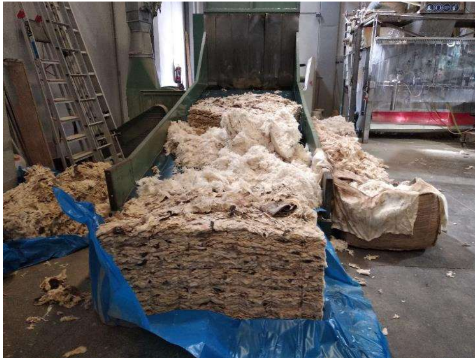
Foto 41. Llana neta cap a la màquina d'apertura de fibres a MONLAN. Font: Pròpia (2022).
