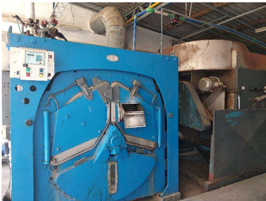
Foto 44. Rentadora adaptada de Poraxa. Font: Pròpia (2022).
