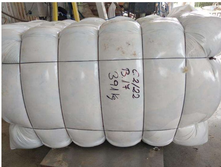
Foto 38. Bala de llana a punt per enviar, amb les dades de traçabilitat (C = cartilla; B = núm. de bala; pes de la bala). Font: Pròpia, a partir de les entrevistes realitzades (2022).
