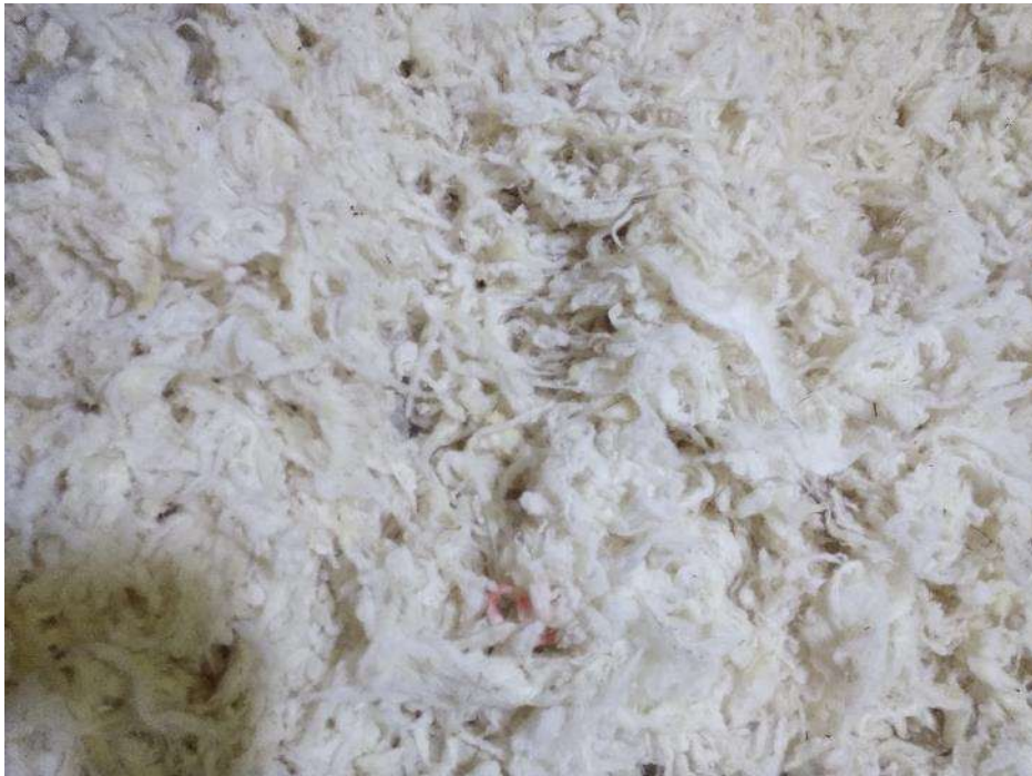
Foto 50. Llana resultant després de tot el procés de rentat a Lanas Payo. Font: Pròpia (2022).
