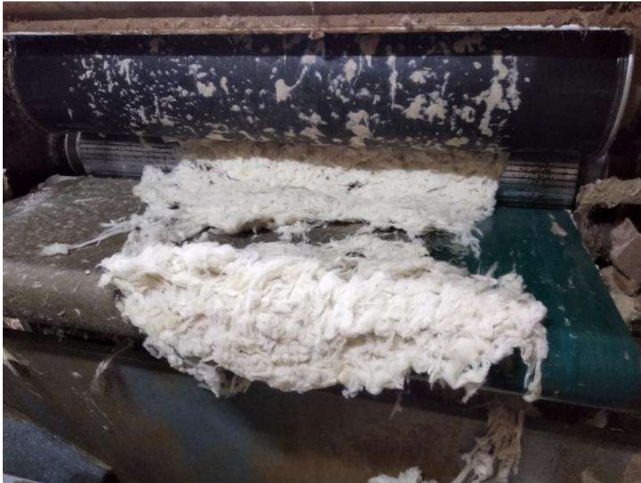
Foto 49. Llana neta just abans de passar a l'assecador a Lanas Payo. Font: Pròpia (2022).
