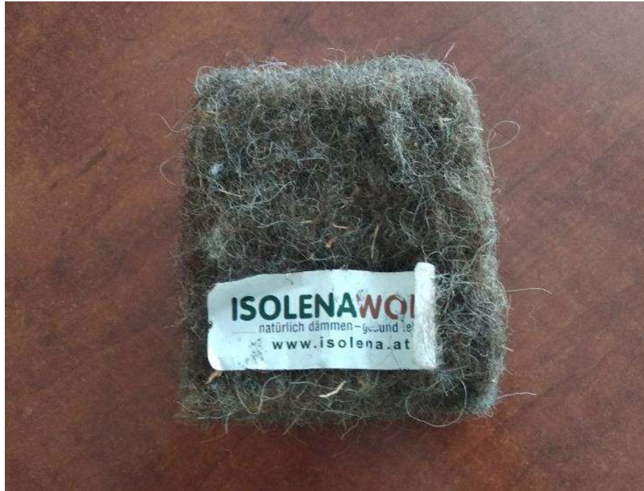
Foto 55. Mostra d'aïllament tèrmic de llana. Font: Pròpia (2022).
